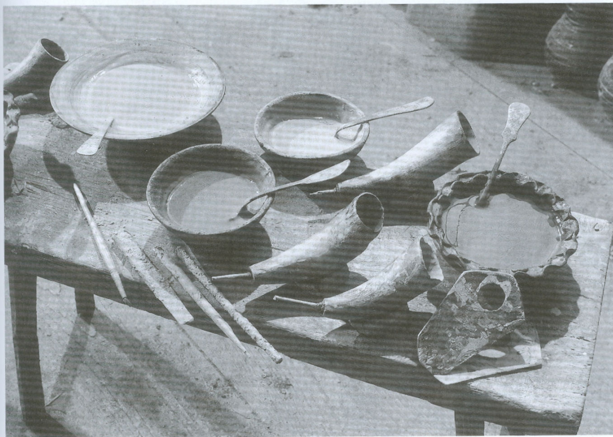
18 Pomocné hrnčiarske nástroje, rožky, nožíky, kolíky, v miskách tekutej hlinky na výzdobu Pottery tools: „horns“ slip trailers, knives, pegs, and in the bowls, liquid clay slips used for decoration.
