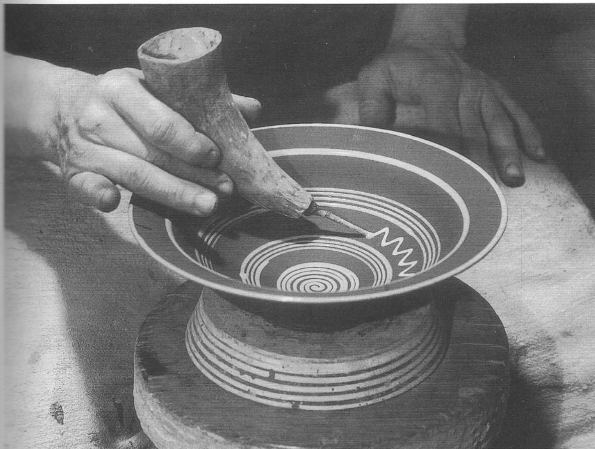
22 Zdobenie pomocou rožka, Pozdišovce 1950 Decoration of a bowl using a „horn“ slip trailer, Pozdišovce 1950
